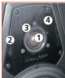
Vue du tweeter à dôme hémisphérique 1 - Dôme souple de 29 mm en tissu traité. 2 - Système de découplage par rapport au baffle support. 3 - Non visible, circuit magnétique avec décompression arrière. 4 - Plaque support de référence mécanique très stable.
